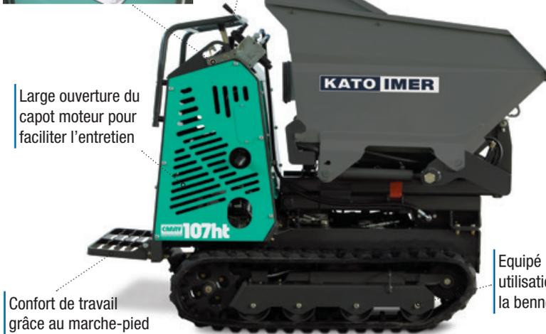
Confort de travail grâce au marche-pied large et repliable
