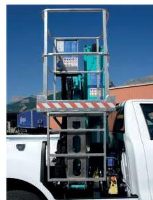
Mise à part la hauteur du véhicule en ordre de marche qui passe à 2.60 m, on garde le gabarit d'origine du véhicule y compris la caisse arrière que l'on peut fermer par un coffre ce qui permet de circuler avec un outillage en toute sécurité.
