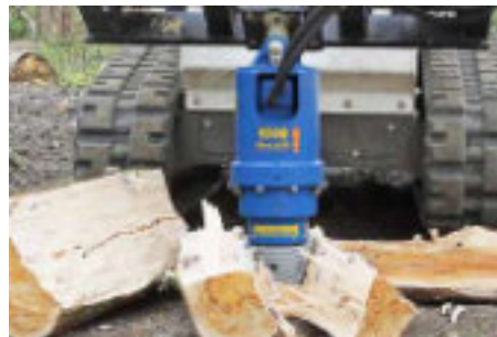
Attelage pour fendeuse de bûches avec kit de verrouillage
