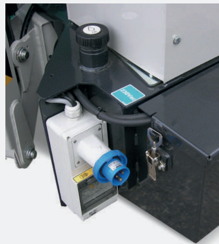
Panneau de commutation magnétothermique et entrée de ligne électrique 220 V et disjoncteur 30 mA
