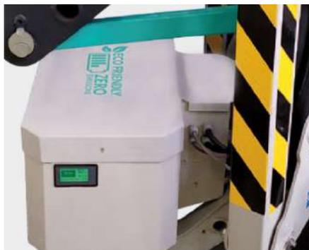
Compartiment batteries lithium protégé et facilement accessible pour la gestion du cycle de charge. Ecran LCD pour vérifier l'état de charge et le temps restant de la batterie.
