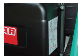
Jauge d'indication niveau gasoil
